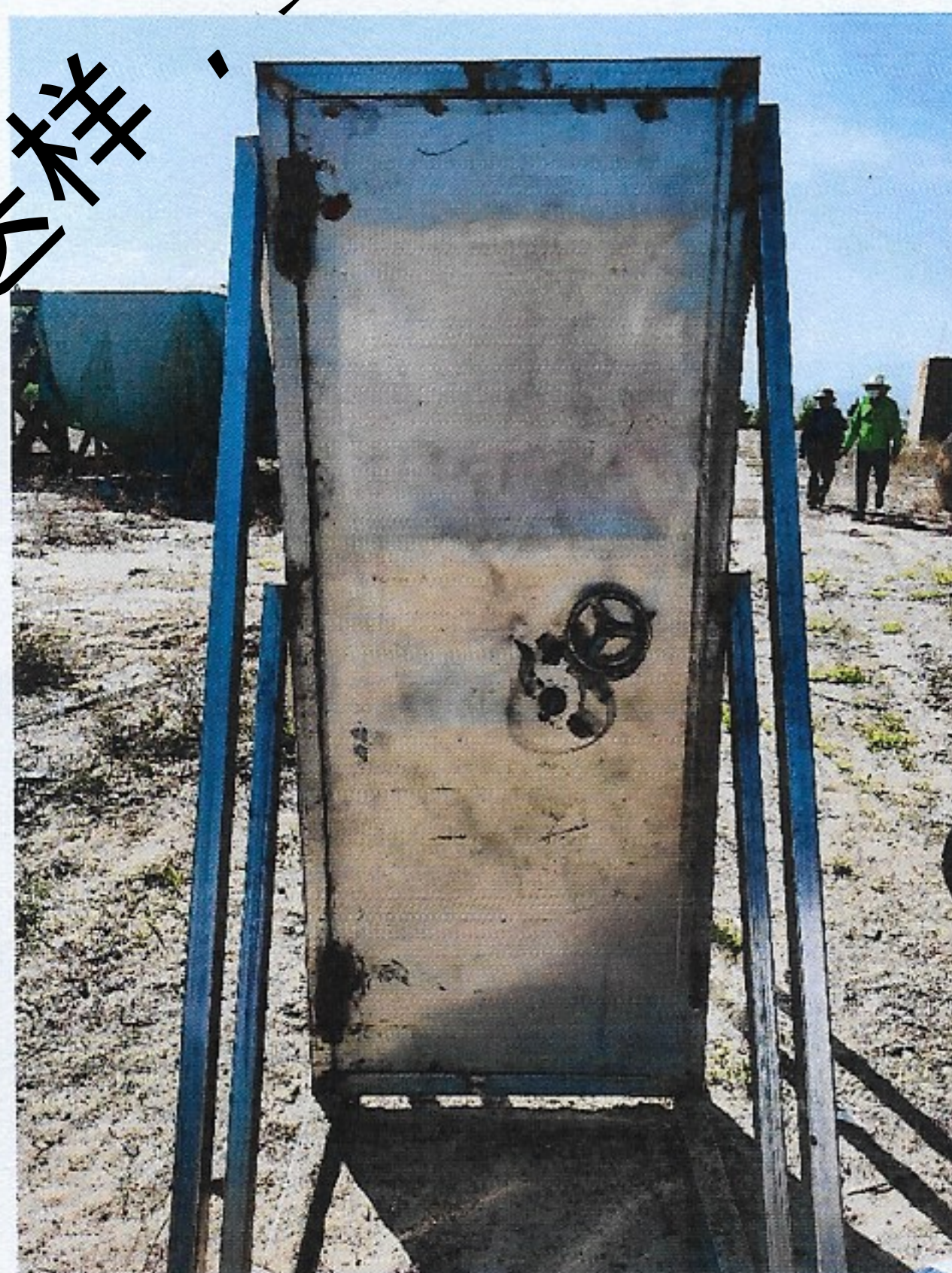
图二: 爆破试验后, FBK-ZDXF 型防爆门外观状态
