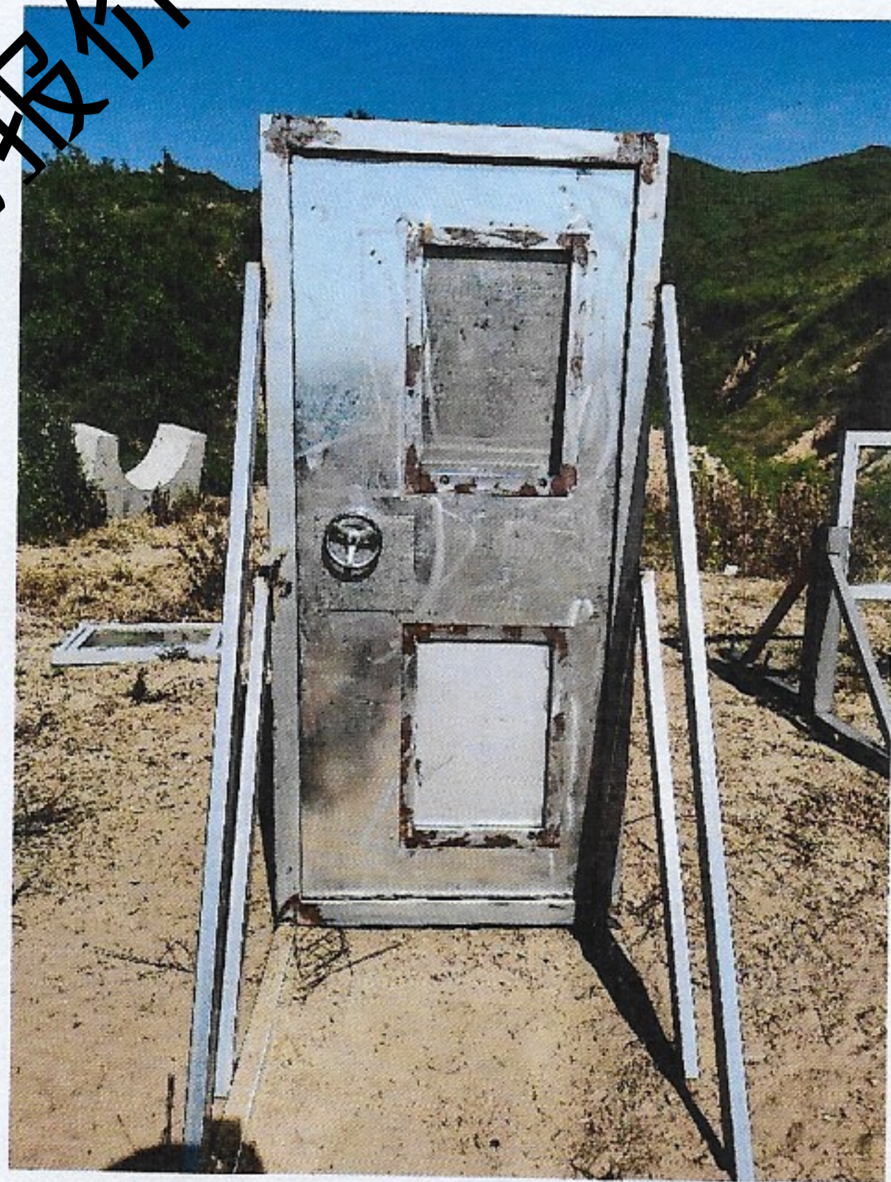
图二: 爆破试验后, XBM-ZDXF 型泄爆门外观状态
